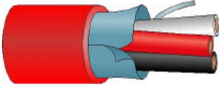
Cable coaxial balanceado para altavoces. Cable de 100 Voltios para uso profesional. Es un cable fabricado especialmente para ser utilizado en instalaciones de altavoces con líneas de 100 Voltios. Sistema Retard. Anulación de interferencias de los móviles. Resistente al fuego 180 minutos.
